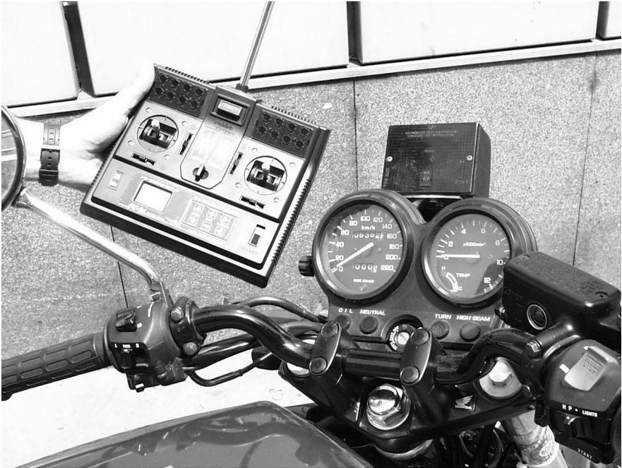
Abbildung 2: Fernsteuerung und Signalleuchte zur Übermittlung der Bremsreaktionsaufforderung an die Versuchsperson
