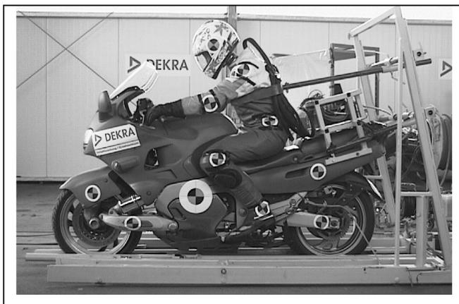
**Bild 3** Dummy auf dem Motorrad in versuchsfertigem Zustand
