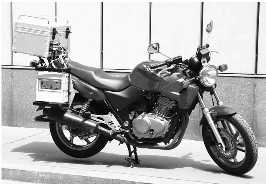
Abbildung 1: Ansicht des Meßmotorrades Honda CB500 mit montierter Meßausrüstung
