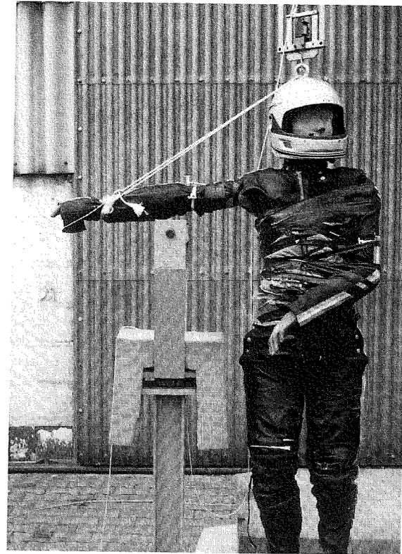
Bild 3: Versuchsanordnung I ohne Anpralldämpfer
