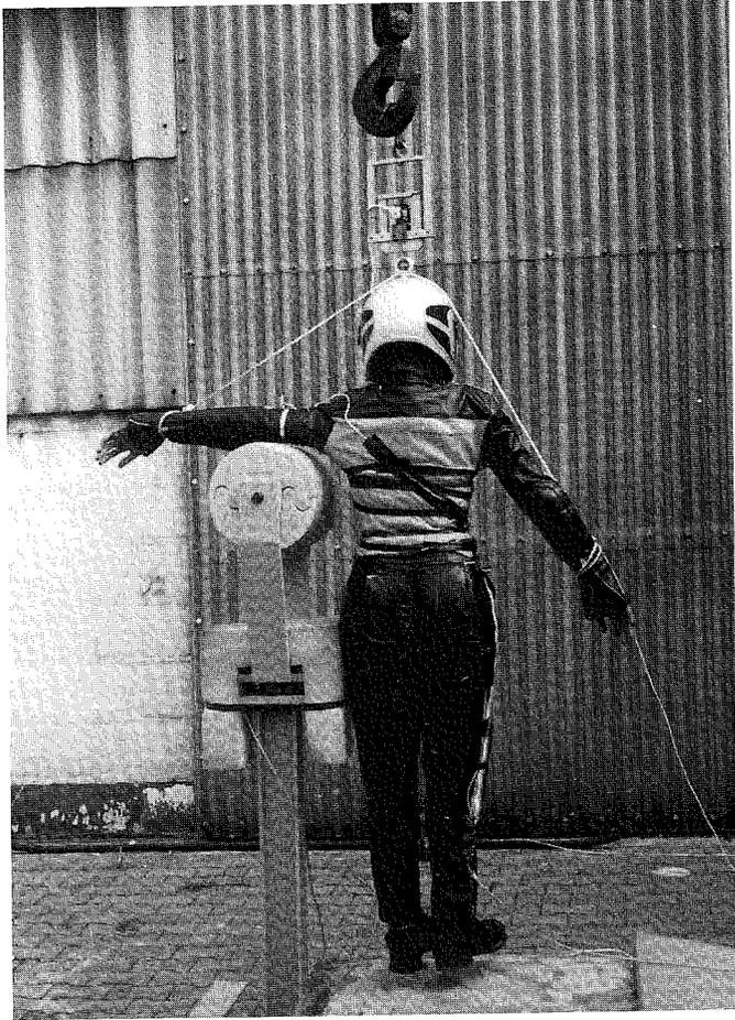
Bild 2: Versuchsanordnung I mit Anpralldämpfer
