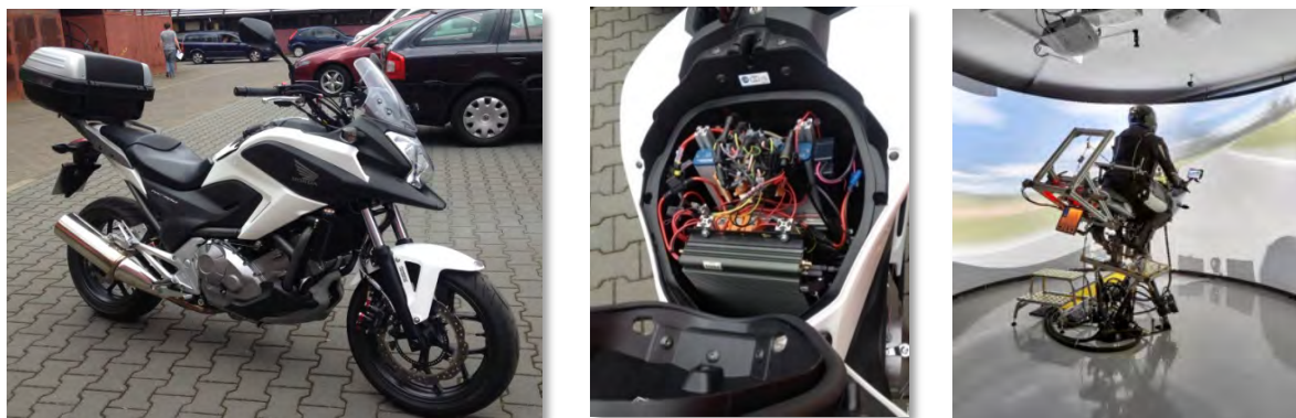
Abb. 4: Messwerkzeuge – links Messmotorrad Honda NC700X, rechts DESMORI Motorradfahr Simulator.
