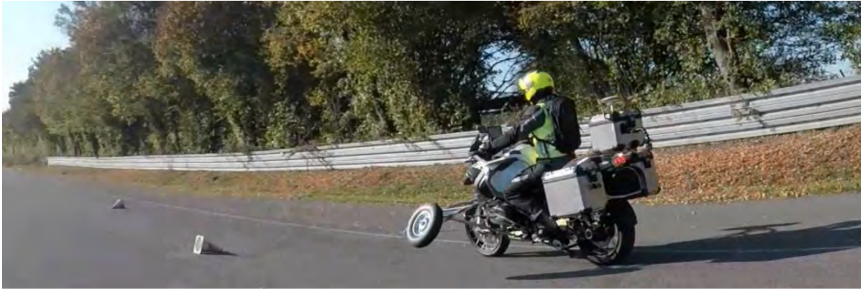
Abb. 11: Assistierte Versuchsfahrt mit längsdynamischem Eingriff vor der Kurve.
