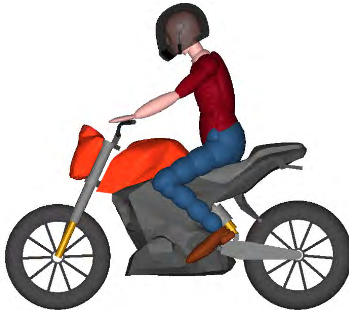
Abb. 2: Motorradmodell LMU und Ellipsoid-Menschmodell MADYMO mit MATD-Kopf und Helm.
