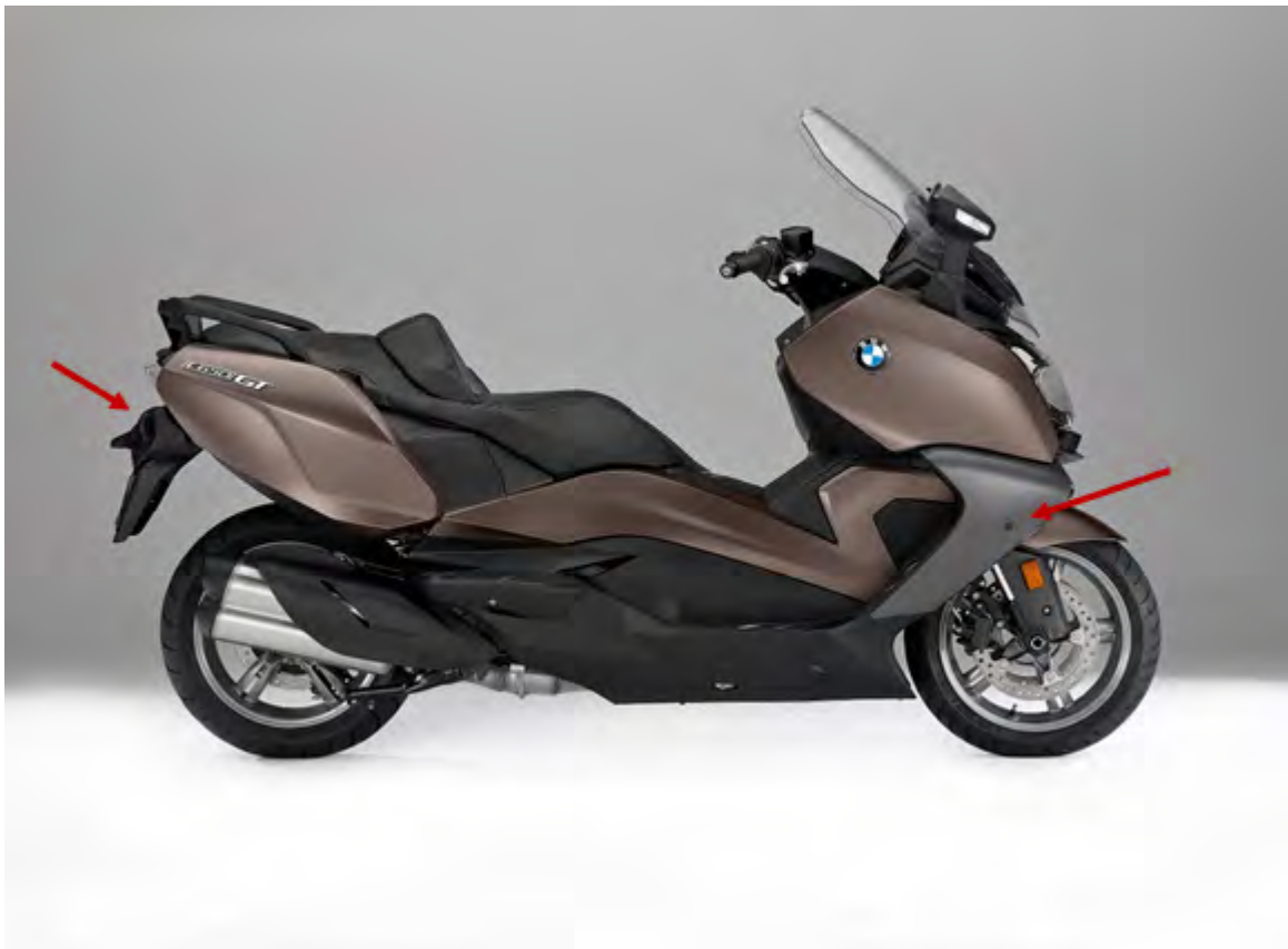
Abbildung 2. Positionierung der Ultraschallsensoren im Bereich der Frontverkleidung und des Kennzeichenträgers am Maxi-Scooter BMW C 650 GT
