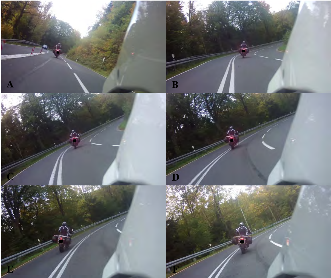
Abb. 3-9. Unbeabsichtigtes Verlassen der Fahrspur
