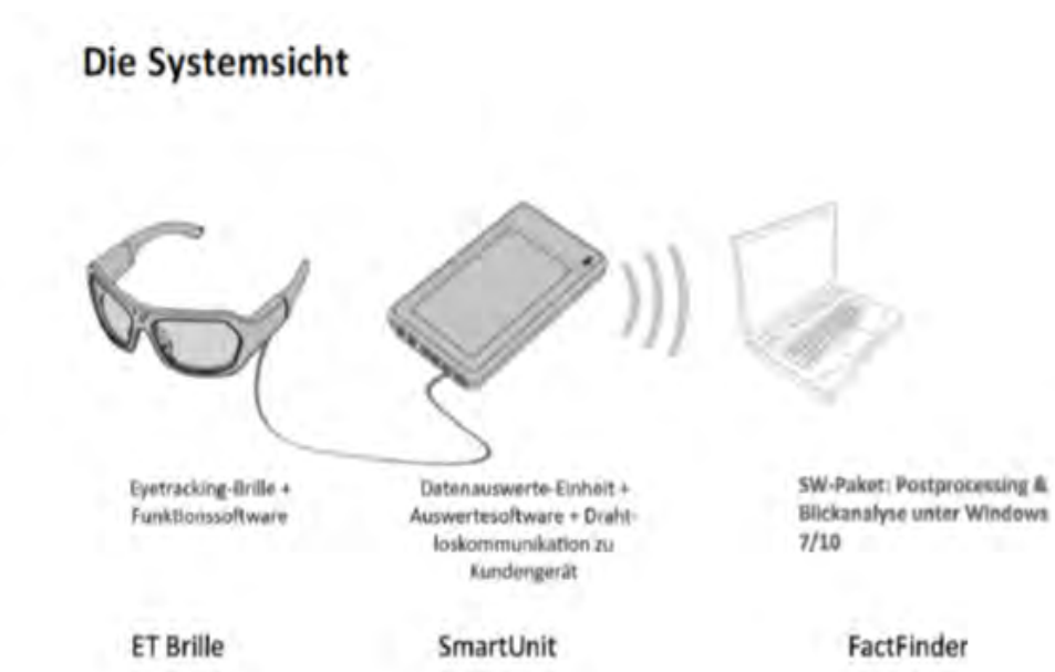
Abb. 2. Eye-TrackingBrille – Systemübersicht (Viewpointssystem GmbH 2016)
