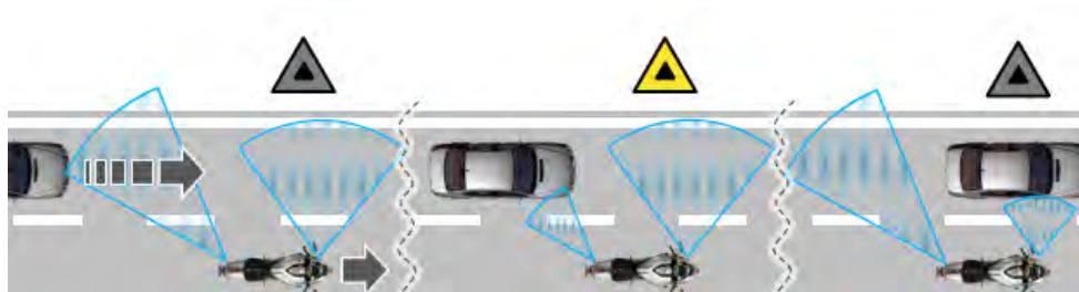
Abbildung 4. Warnszenario Side View Assist
