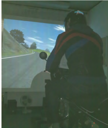
Abbildung 1: Darstellung des Wankwinkels über entsprechende Kameradrehung.
