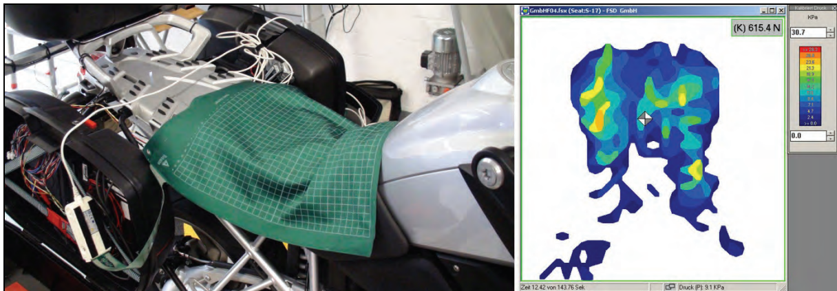
Abb. 2-4 Fahrersitz mit einer Sensormatte
