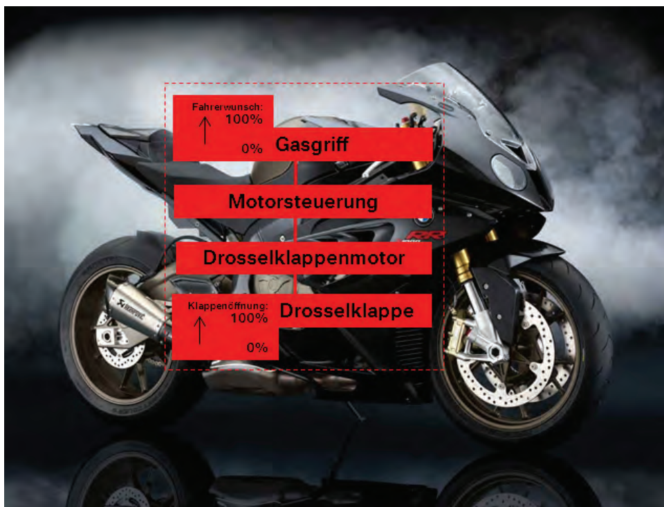
Bild 5: BMW S 1000 RR, schematische Darstellung des E-Gas Konzeptes.
