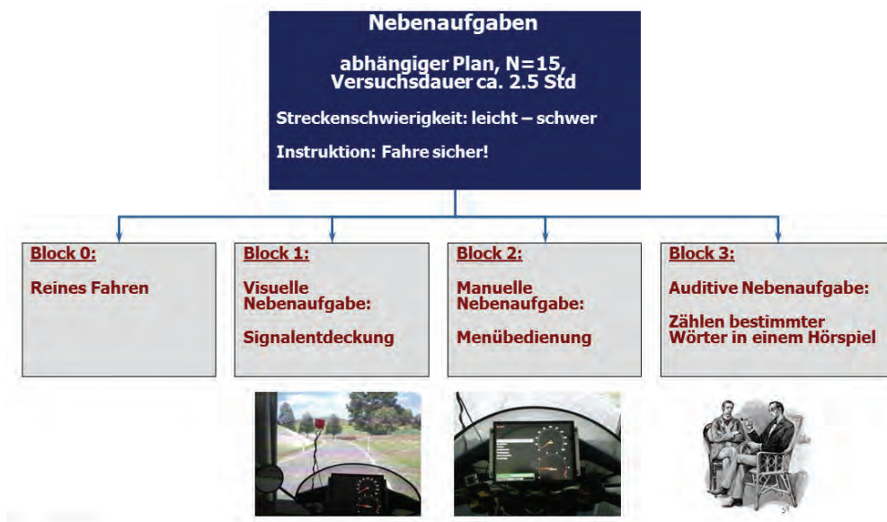
Abbildung 3: Schematischer Untersuchungsplan zur Auswirkung verschiedener Nebenaufgaben auf Beanspruchung und Fahrverhalten beim Motorradfahren.
