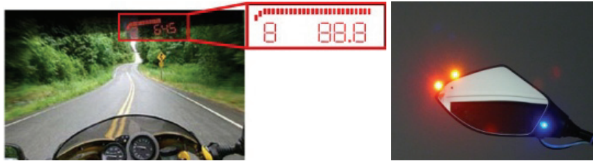
Abbildung 3: HUD (links) und LEDs im Spiegel (rechts).
