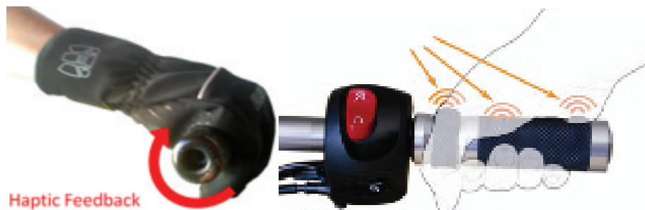
Abbildung 4: Force Feedback Gasgriff (links) und haptischer Gasgriff (rechts).
