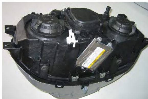
Abb. 4: Integration des Xenon-Steuergerätes im Scheinwerfergehäuse (Unterseite)
