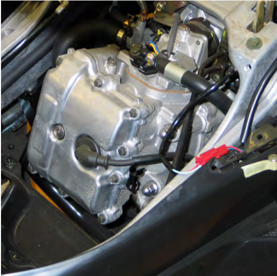
Bild 14: YP-400-Einzylinder-4-Takt- Hubkolbenmotoreinbau (PERAVES-Archiv)
