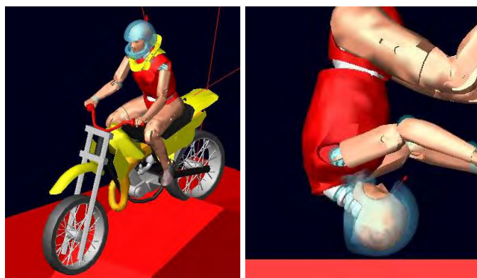
Abbildung 5: Motorrad schlägt zu kurz auf dem Sprung auf (links); Sturz Kopf voraus führt zu einer Hyperflexion (rechts)
