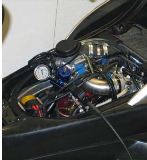
Bild 15: PKM-16 aufgesetzt auf Triebssatzschwinge des YP-400 anstelle von Kopf und Zylinder des Hubkolbenmotors (PERAVES-Archiv)
