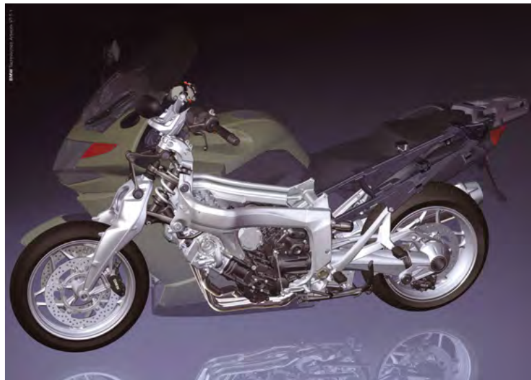
Abb. 8: Fahrwerk BMW K1200GT. Duolever Vorderradführung/Paralever Hinterradführung
