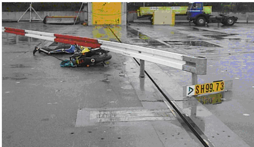
Abbildung 12: Rutschender Anprall an passiver Schutzeinrichtung, DEKRA
