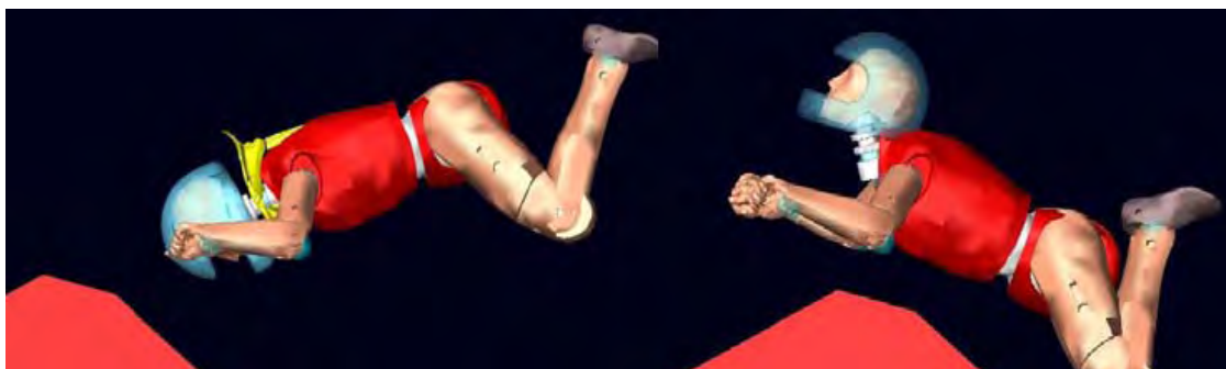
Abbildung 7: Dummy (mit Neck-Brace-System) vor dem Aufschlag (links); Hyperextension (ohne Neck-Brace-System) nach dem Aufprall (rechts)
