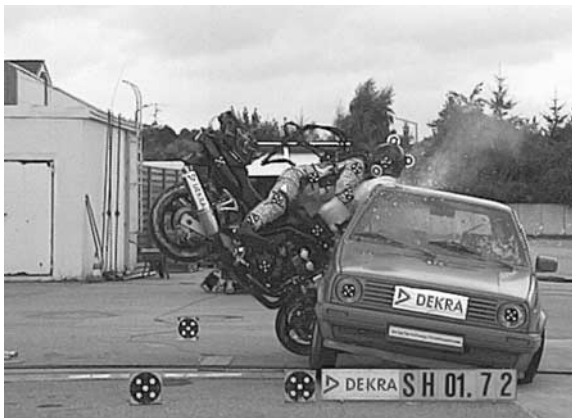
Bild 5 Full-Scale-Versuch Yamaha FZS 600 mit Airbag gegen einen stehenden VW Golf II (2-Türer) [07/]
