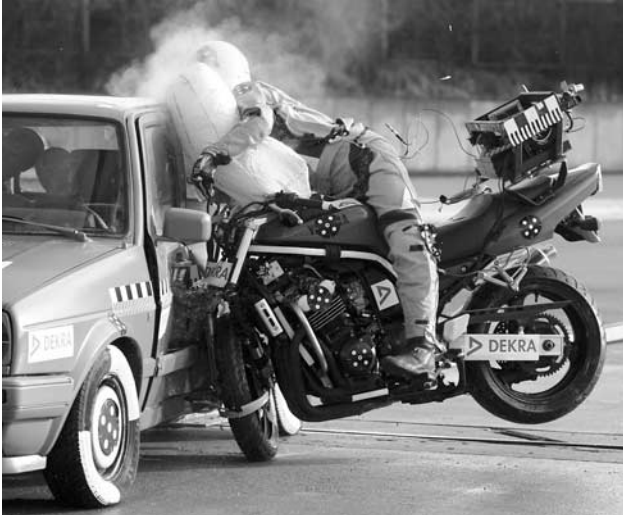
Bild 9 Full-Scale-Versuch Yamaha FZS 600 mit Airbag gegen einen fahrenden VW Golf II (4-Türer)
