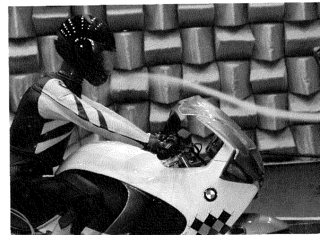
Abb. 3: K 1200 RS, 102 dB(A) Der Luftstrom wird durch das Windschild umgelenkt und die laminare Strömung trifft mit erhöhter Geschwindigkeit auf das Windschild
