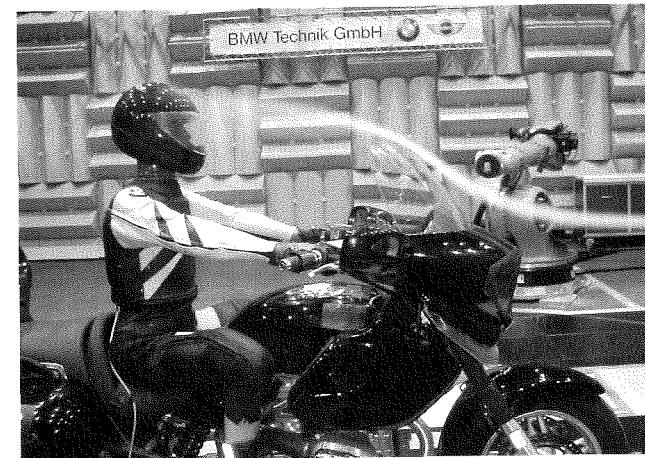
Abb. 2: R 1200 CL, 90 dB(A) Der Luftstrom wird durch das Windschild umgelenkt und die nicht laminare Strömung trifft mit reduzierter Geschwindigkeit auf den Helm
