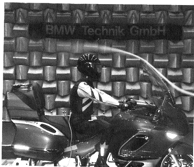
Abb. 5: K 1200 LT, 81 dB(A) Der Luftstrom wird vollständig über den Fahrerkopf geleitet, so dass für den Fahrer keine Luftströmung spürbar ist.
