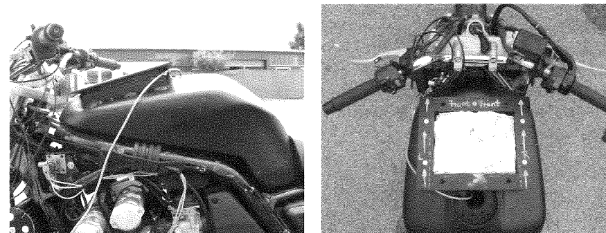
Abb. 8: Anbringung des Airbagmoduls auf dem Versuchsmotorrad
