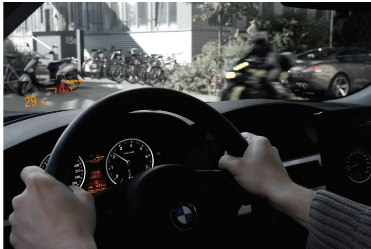
Abb. 5: Warnsymbol des kommunikationsbasierten Querverkehrsassistenten im Instrumenten-Kombi und dem Head-Up Display
