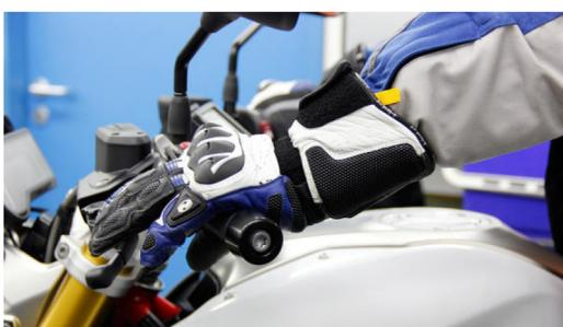
Bei ausgestreckter Hand zu Brems- und Kupplungshebel sollten Unterarm, Handfläche und Finger des Fahrers eine gerade Linie bilden.
