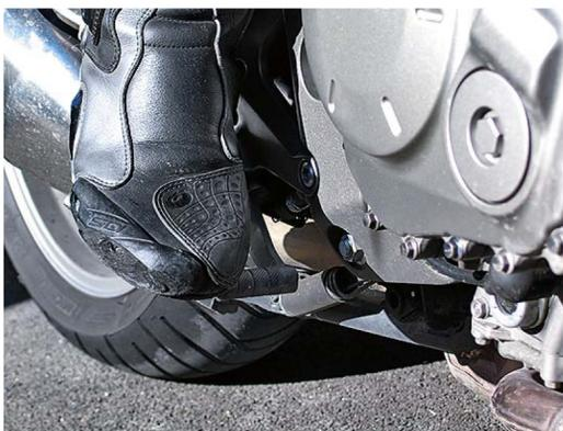
Das Bremspedal sollte so tief justiert werden, dass der Fuß des Fahrers locker darüber ruht und er bei Bedarf sofort zutreten kann.
