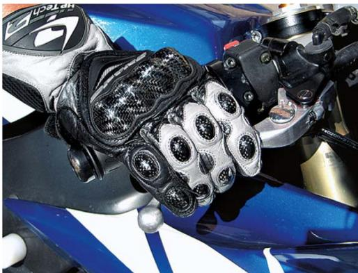
Die Weitenverstellung des Bremshebels funktioniert oft per Einstellrad (rechts, Mitte). Entfernung so einstellen, dass alle Finger zupacken.
