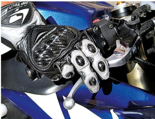
"Zwei-Finger-Bremser" benötigen meist eine größere Reichweite, damit die Finger, die den Lenker umfassen, nicht eingeklemmt werden.
